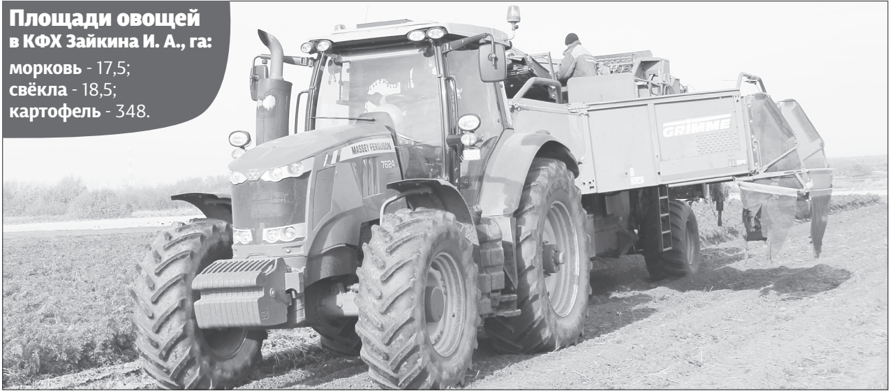
Картофелеуборочный агрегат вполне может справиться и с морковью, если его перенастроить /ФОТО АВТОРА
