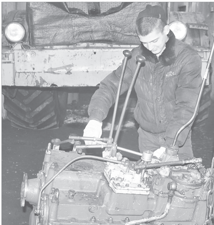
Слесарь Андрей Зуенок занимается установкой коробки передач К-700 после капитального ремонта
