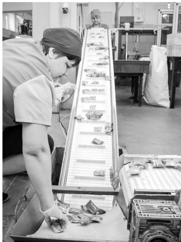
рационализаторская работа. Например, сейчас совершенствуется конвейерная система участка упаковки, чтобы конфеты автоматически, без применения ручного труда, фасовались в коробки.
