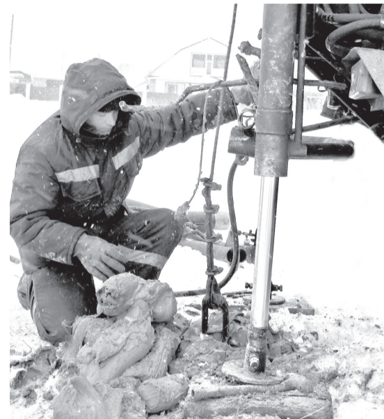
• Сергей Морозов, техник-геолог ООО «ПРИЗ», уверяет, что работе современной буровой техники холода не помеха: она рассчитана на эксплуатацию в погоду до -20°.
