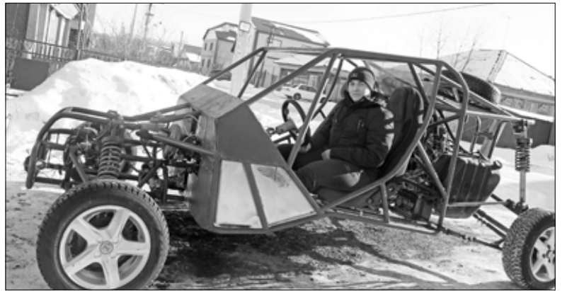
На багги Ивана Пономарёва установлены двигатель, коробка передач, мосты от ВАЗ-21099. И только руль – настоящего спортивного авто
