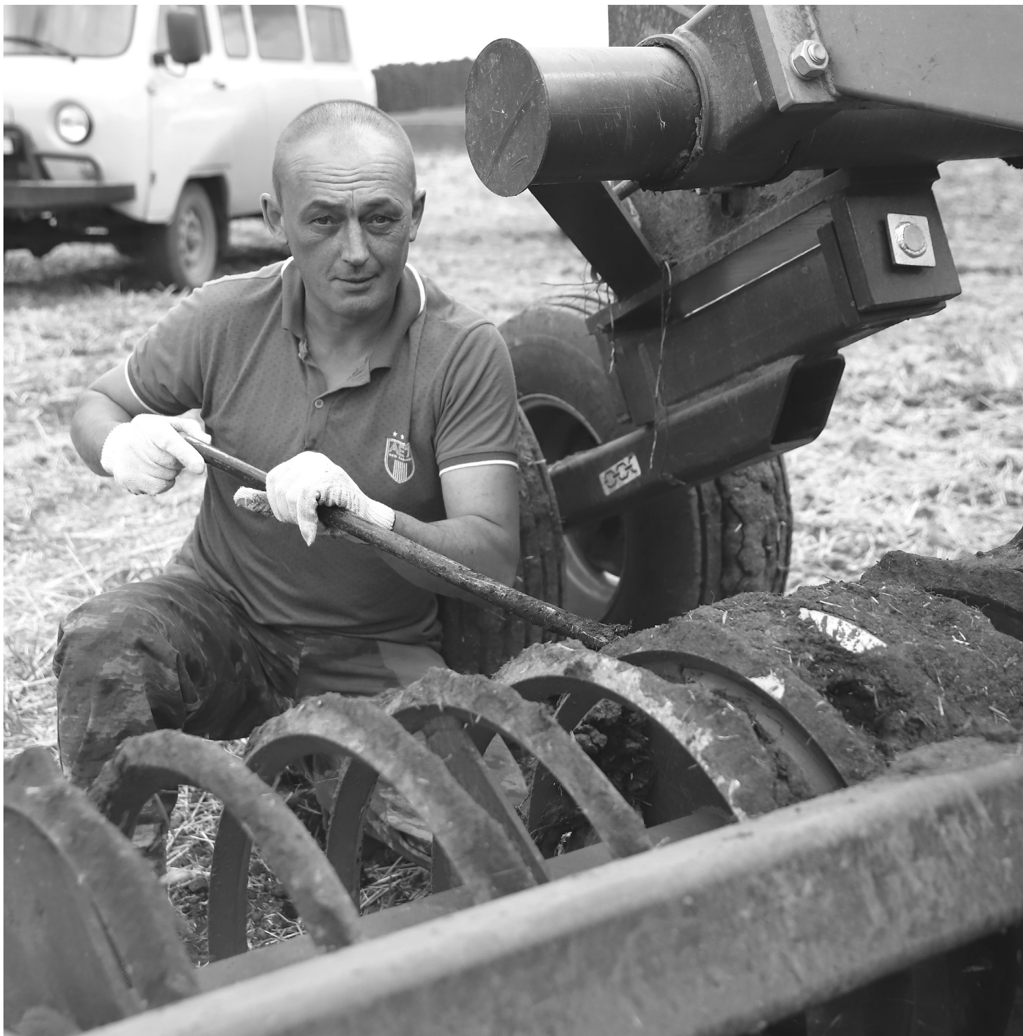
Александр Совину, как опытному механизатору СПК «Артур», доверили работу на новом посевном комплексе и «Кировце». Сырая земля забивает сеялку – приходится останавливаться и очищать агрегат вручную
