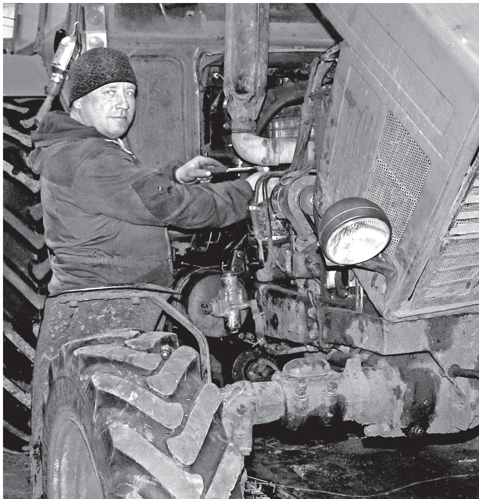
• Павел Баранцев, механизатор ООО «Крестьянское хозяйство «Дружба», занят ремонтом тормозной системы трактора МТЗ-82.
