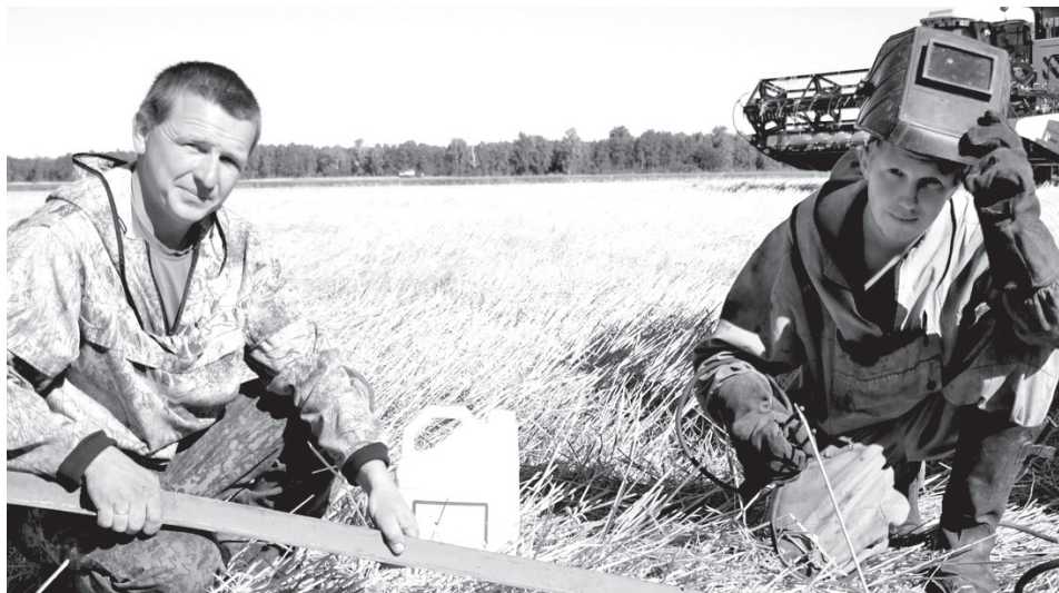
• Сварщик Александр Двойников (справа) и слесарь Леонид Волков из ООО «Согласие» готовят стяжку: у КамАЗа, вывозящего зерно от комбайнов, надо укрепить борт.
