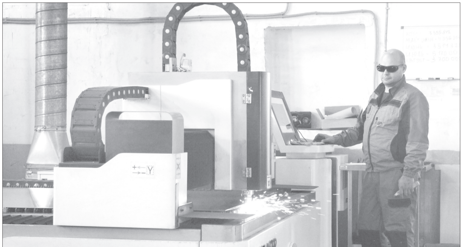
Для работы на оборудовании его нужно запрограммировать. Лазерная резка тоже управляется компьютером /ФОТО АВТОРА
