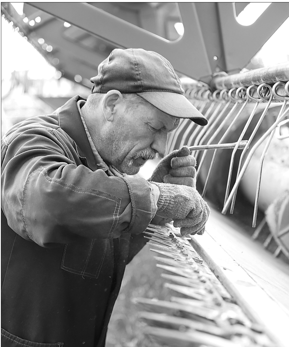
Механизатор Анатолий Носов меняет режущий аппарат – механизм, который косит колос. Старые детали проржавели, отработали пять сезонов. Нужно закрепить на жатке 60 ножей
