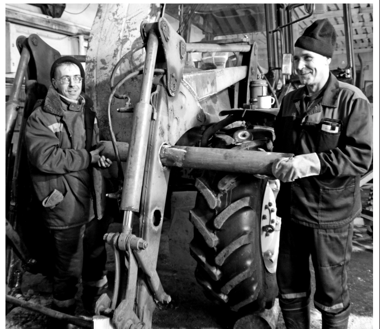
• Николай и Василий Игнатовы трудятся в ООО «Возрождение» не один год. Вдвоём отец и сын за один день полностью восстановили КУН у МТЗ, переварив опорные трубы на стреле и перебрав все четыре подъёмных гидравлических цилиндра. На очереди у мастеров – ремонт трактора.
