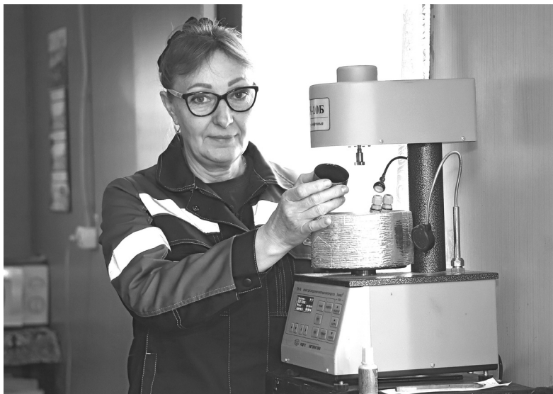
Нина Козлова испытывает битум на пенетрометре
