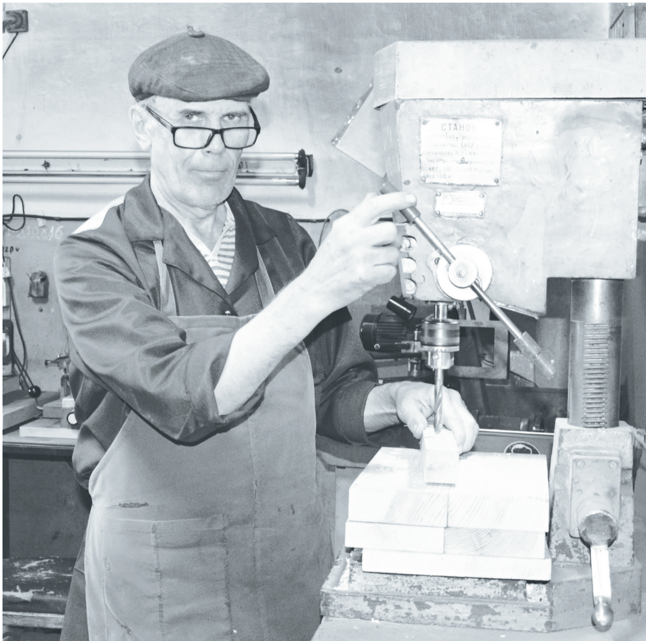
Анатолий Ефимцов на станке высверливает отверстия для крепления деталей.
