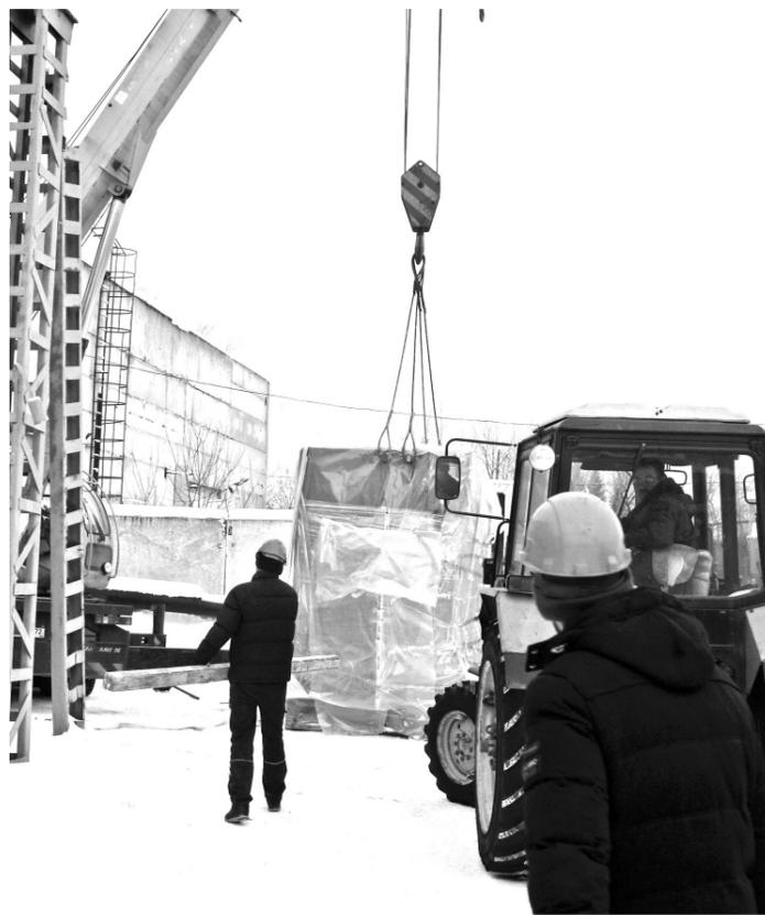
• Тюменские такелажники начали подготовительные работы к перемещению тяжеловесного габаритного станка в цех машзавода: в ход шли не только тележки и низкорамные платформы, но и привычный деревянный брус.
