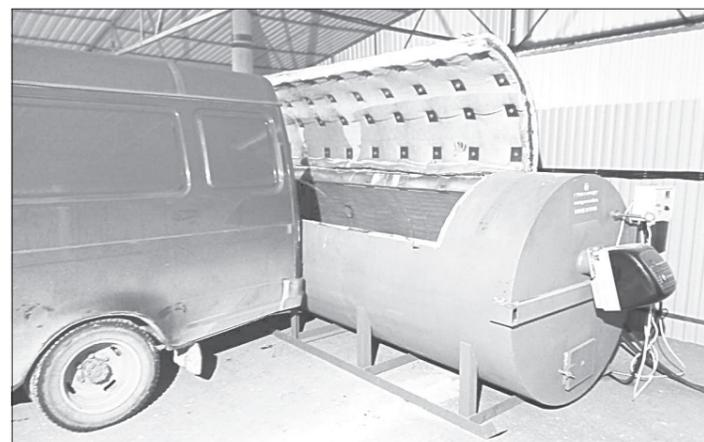
Эта печь с верхней загрузкой называется крематором и способна за один раз принять до трёх тонн спецгруза
