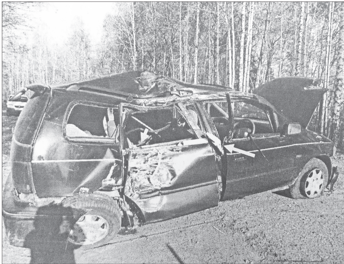
Вид повреждений на корпусе правой стороны автомобиля. Стрелкой указаны фрагменты дерева. / ФОТО ИЗ ВТОРОГО УГОЛОВНОГО ДЕЛА.
