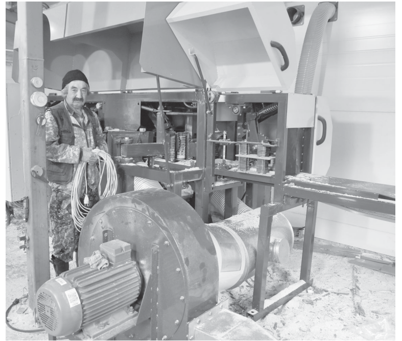
Искандер Шамиров проводит наладку станка КРАОС упт-280к
