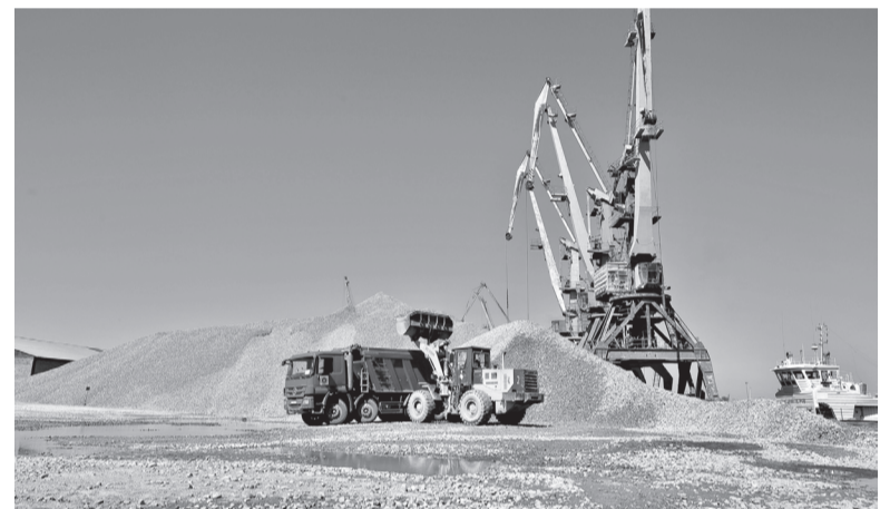
Краны поднимают за один раз до 16 тонн груза
