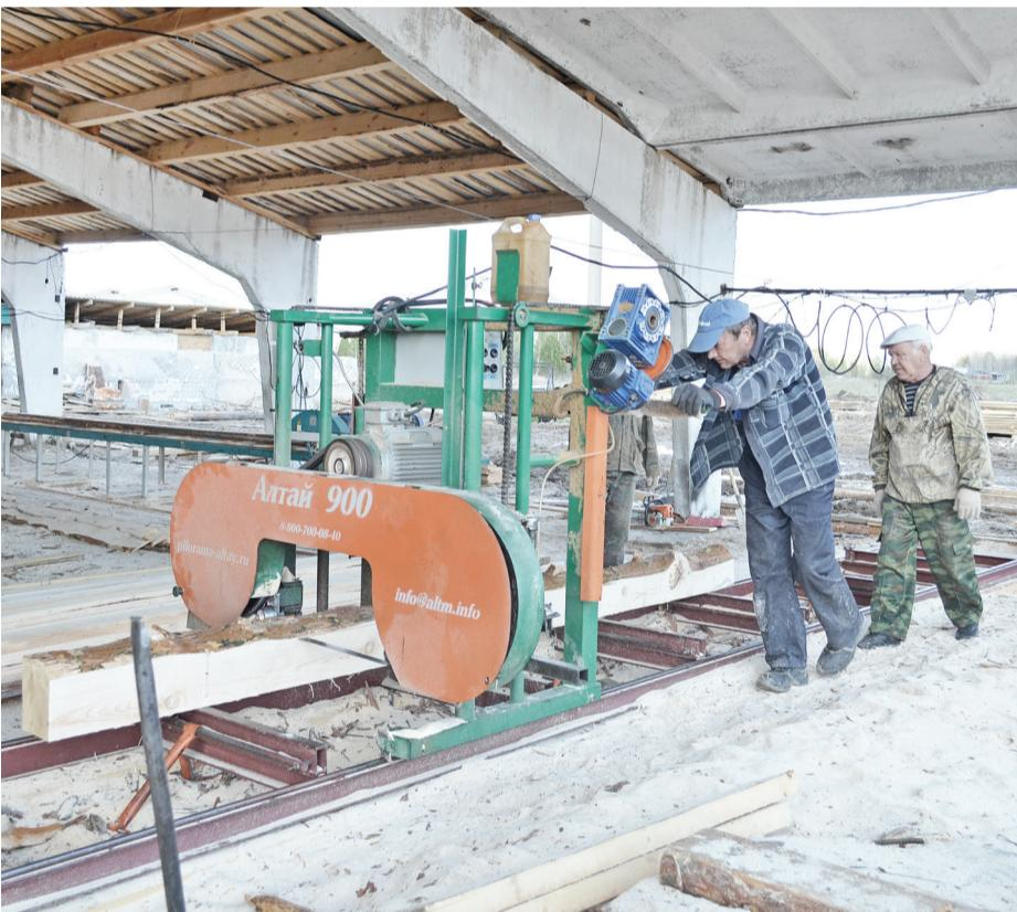
Сегодня малые производства, связанные с переработкой древесины, больше ориентированы на ленточные пилорамы.
