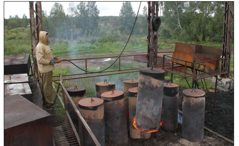
• После пиролиза бочки вынимаются из печи и ставятся в песок, где остывают.
