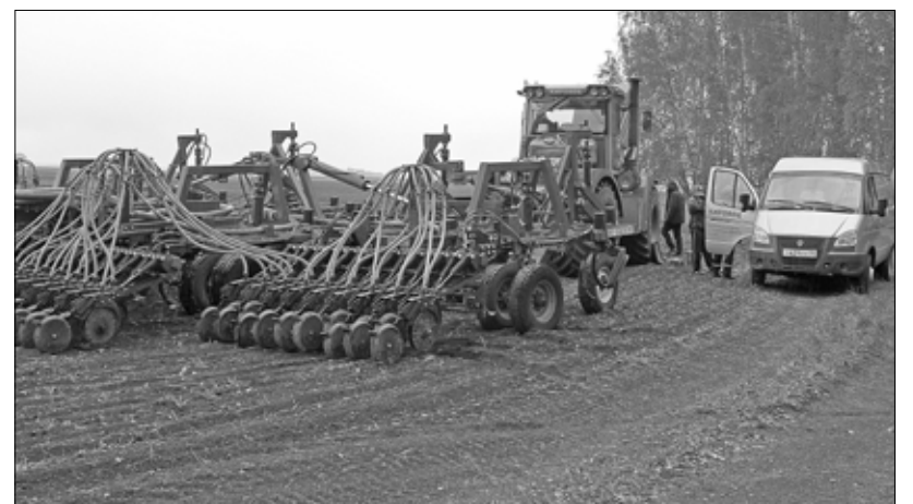
«Кировец» проходит техобслуживание прямо в поле каждые 125 мото-часов
