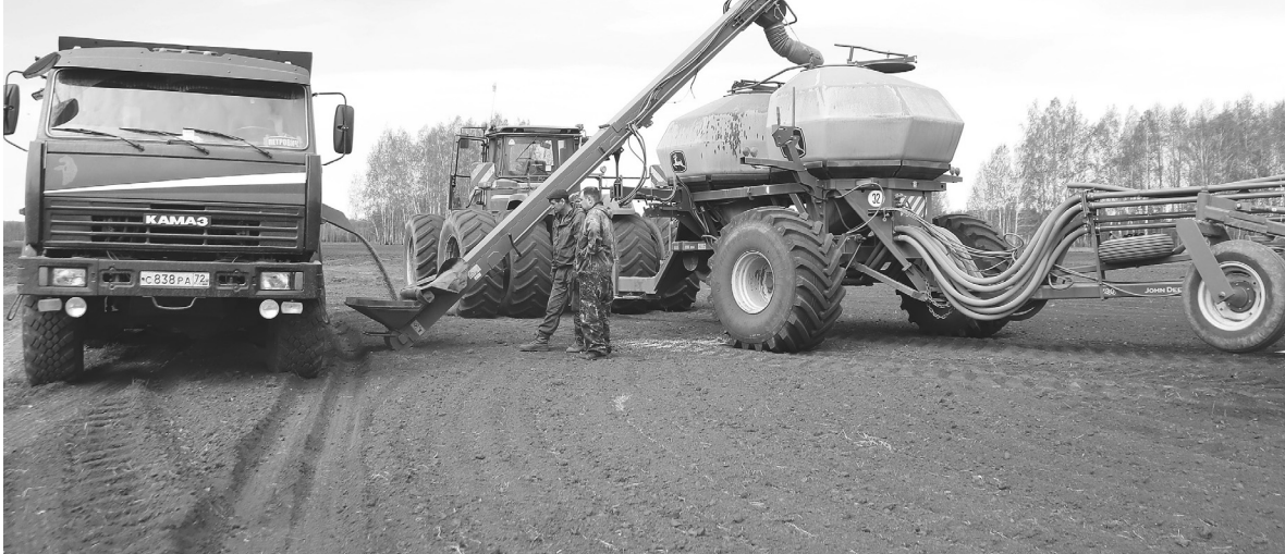
Механизаторы Малышенского отделения ООО СП «Голышмановское» сеют зерновые с одновременным внесением удобрений
