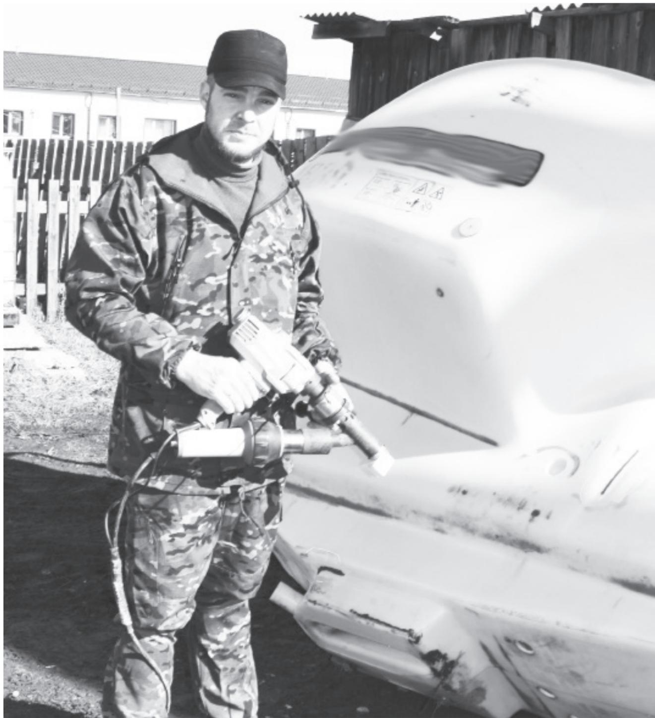
Андрей Рева ручным варочным экструдером залатал пробину в ёмкости опрыскивателя.
