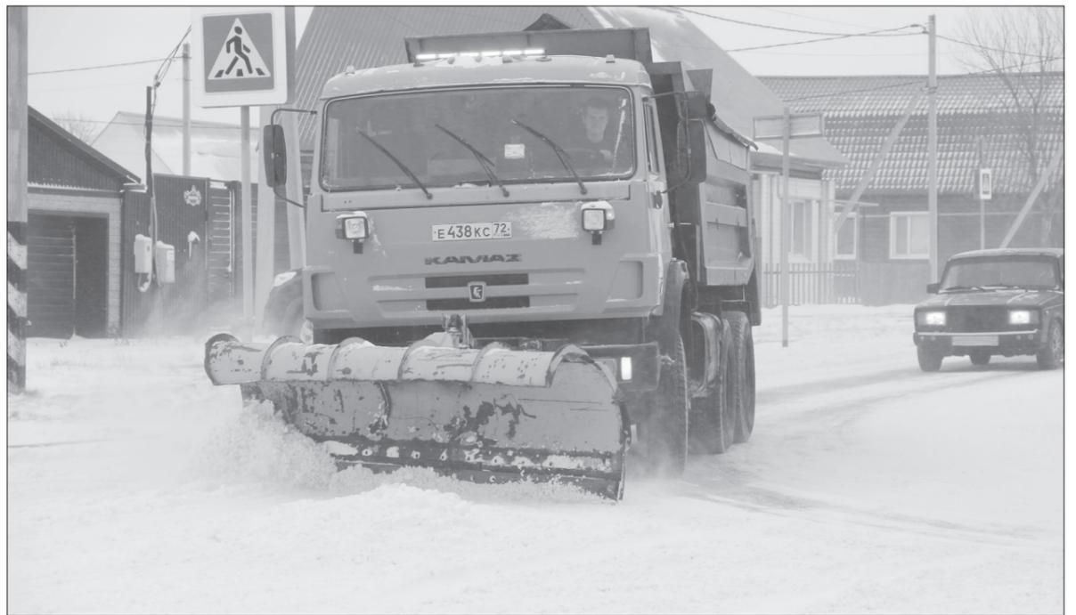
Комбинированные дорожные машины быстро справляются с расчисткой полотна за счёт переднего отвала и подметально-щётчного оборудования
