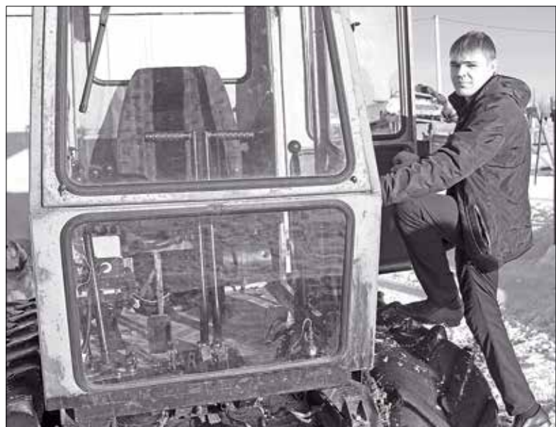
На создание мини-трактора Максим Смирнов использовал два моста, двигатель и тормозные механизмы от «Жигулей», гидравлическую систему от МТЗ-80
