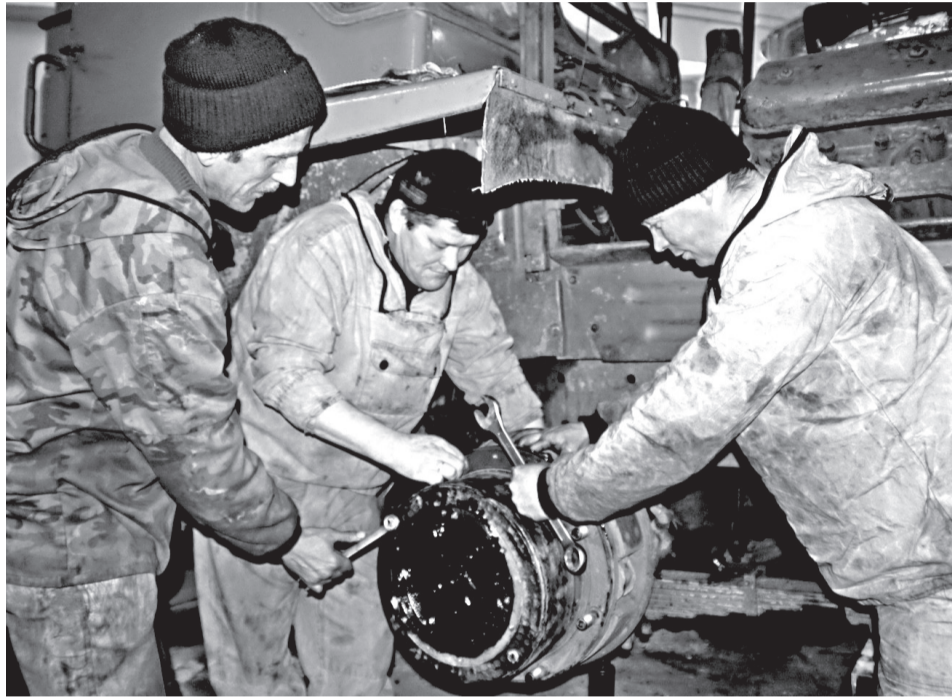
• Механизаторы ООО «Согласие» Валерий Данилов, Николай Чернов и Андрей Калинин (слева направо) подтянут ступицу трактора Т-150, поставят колесо, и машина будет на ходу.
