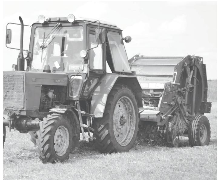
С помощью пресс-подборщика механизаторы заготавливают сено.
