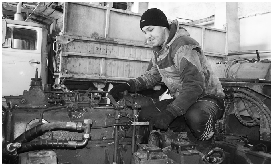
Тракторист Илья Федотов меняет коробку передач на своём Кировце.
