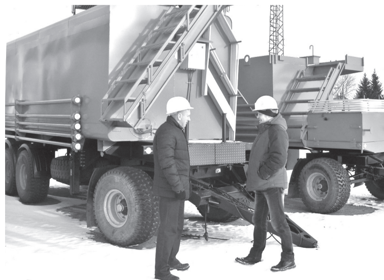
• Александр Майер, начальник экспериментального цеха (слева), и Виктор Шабалин, инженер машзавода, у новой продукции, ждущей отправки заказчику. На переднем плане – ёмкость для долива щелочного раствора для бурения. Агрегат размером меньше служит для очистки бурового раствора от вредных примесей.
