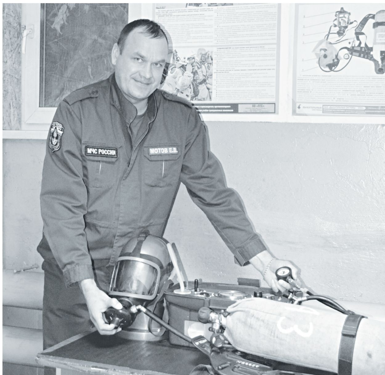
Евгений Мотов проверяет исправность автономного дыхательного аппарата на системе «СКАД».
