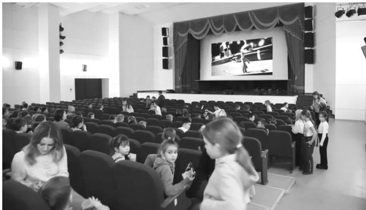
По стенам кинозала развешаны 16 колонок, за экраном размещены два сабвуфера и три усилителя мощности звука
