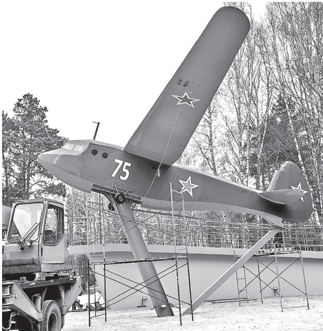
• Макет десантного планёра А-7 в натуральную величину изготовили на Тушинском машиностроительном заводе.
