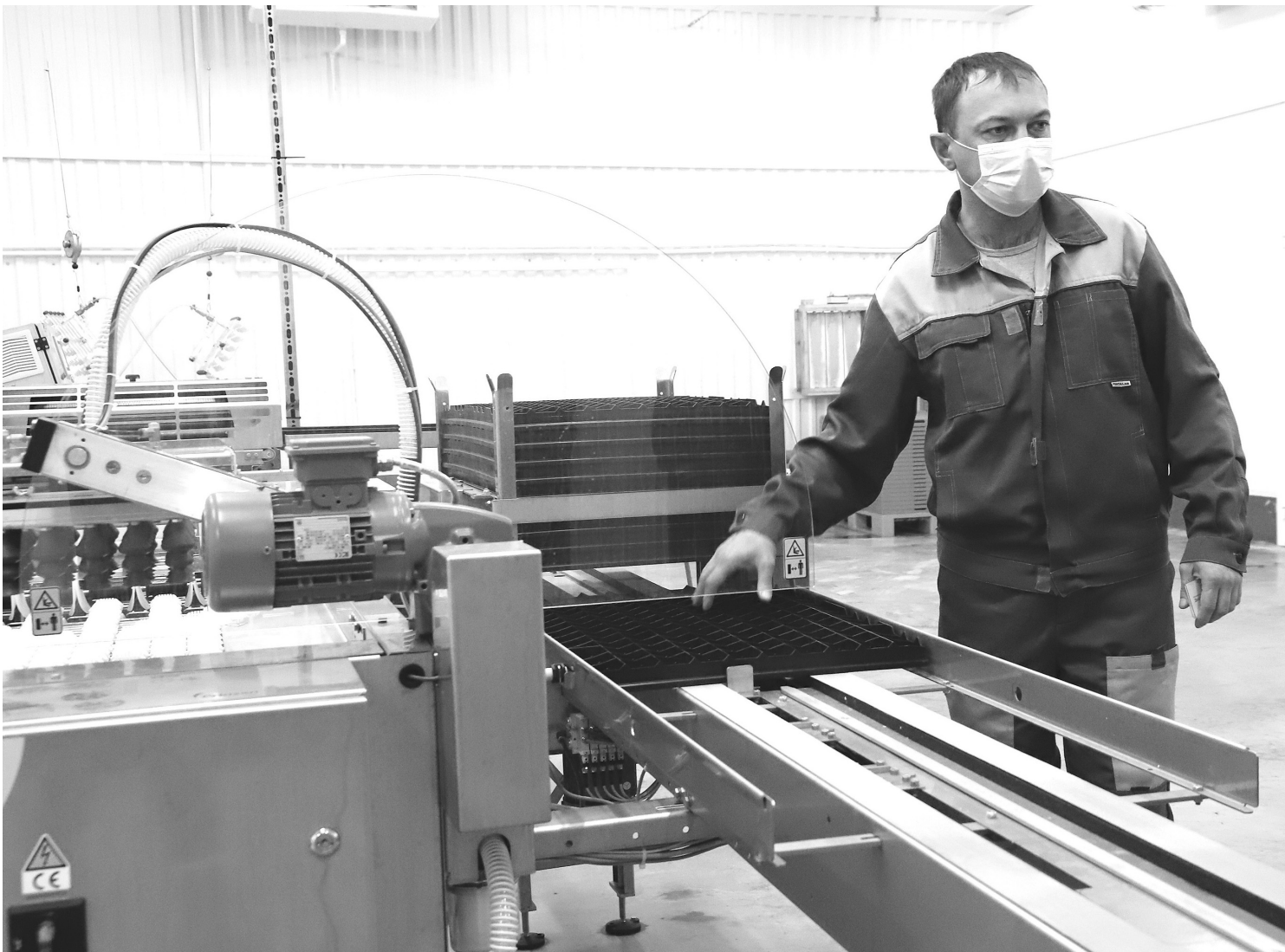
Инженер цеха инкубации Александр Востротин показывает оборудование для вакуумной перекладки яйца
