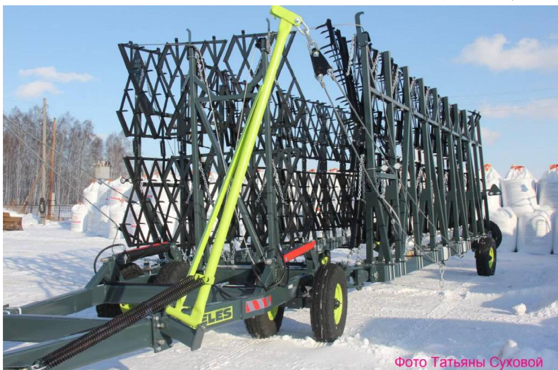
Бороновальная гидрофицированная универсальная сцепка // Фото автора
