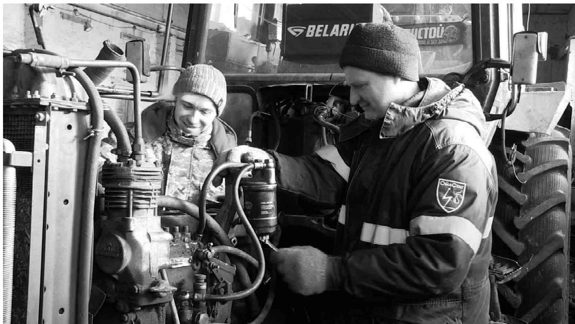
Сергей Решетов (слева) и рабочий зерносушильного комплекса Дмитрий Пономарев заняты установкой двигателя к трактору MT3-82
