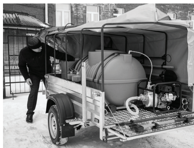
Станция проста в использовании. Представляет собой автоприцеп с ёмкостью для воды и насосом, оснащена пожарными шлангами, шлангами для пополнения запаса воды, шанцевым инструментом (лопатой и ломом), спецодеждой, а также аптечкой. // Фото Василия БАРАНОВА.
