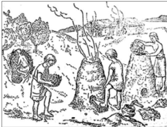
били колотушками губчатое железо (крицу) в холодном состоянии, чтобы «выжать из него соки», т.е. удалить примеси. Затем они догадались нагревать металл и придавать ему нужную форму.
