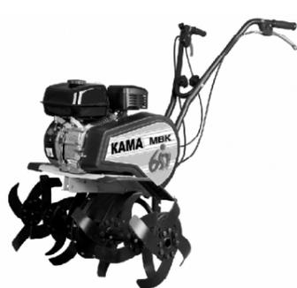
Мотокультиватор с реверсом, оснащен 6 фрезами.
